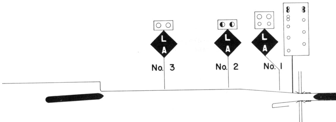
Quand le pont s'abaisse derrière le navire sortant, le signal L/A 2 s'éteint et le signal L/A 1 passe au rouge clignotant et devient fixe dès que le pont est complètement baissé, ce qui indique que le navire peut s'approcher, sans toutefois franchir ce point. (Figure 9)
