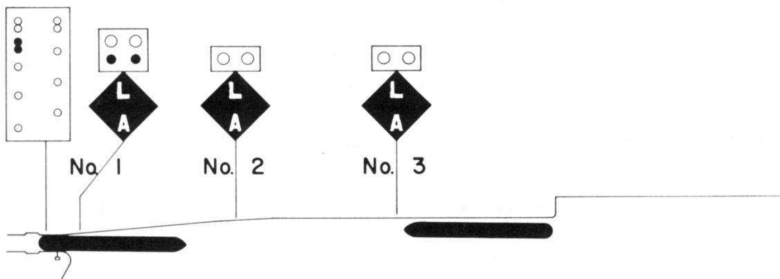
Le point idéal de rencontre de deux navires approchant l'un vers l'autre est celui où la proue de l'entrant et la poupe du sortant sont à la hauteur du signal L/A 2. (Figure 6)
