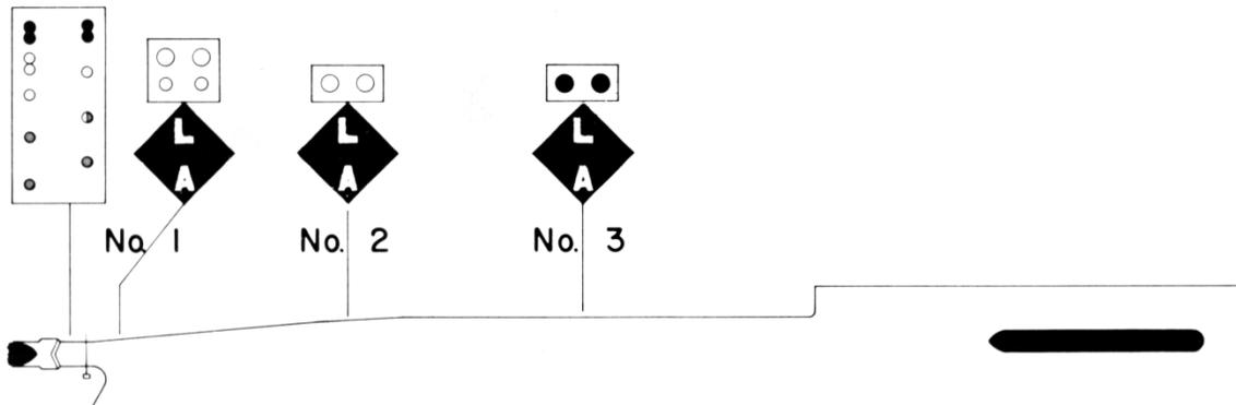
Lorsque les portes de l'écluse s'ouvrent, les feux du signal L/A 3 commencent à clignoter. Au moment où le navire qui est dans l'écluse largue ses amarres, les feux du signal L/A 3 s'éteignent et ceux du L/A 2 commencent à clignoter. Le navire entrant devrait alors être rendu à l'extrémité du mur d'approche. (Figure 4)
