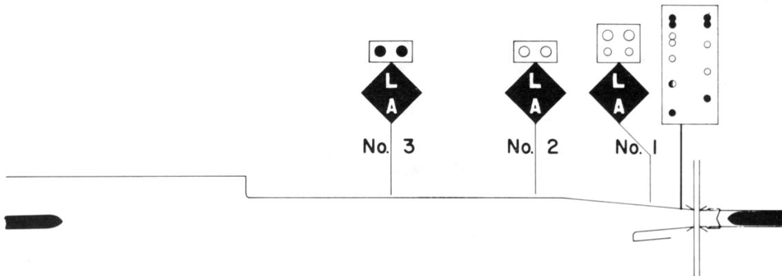
Lorsque les portes s'ouvrent, les feux de circulation et ceux du signal L/A commencent à clignoter. Au moment où le navire sortant démarre, les feux du L/A 3 s'éteignent et ceux du L/A 2 commencent à clignoter, indiquant au navire entrant de s'apprêter à avancer au L/A 1 ou à larguer les amarres pour longer le mur. (Figure 8)
