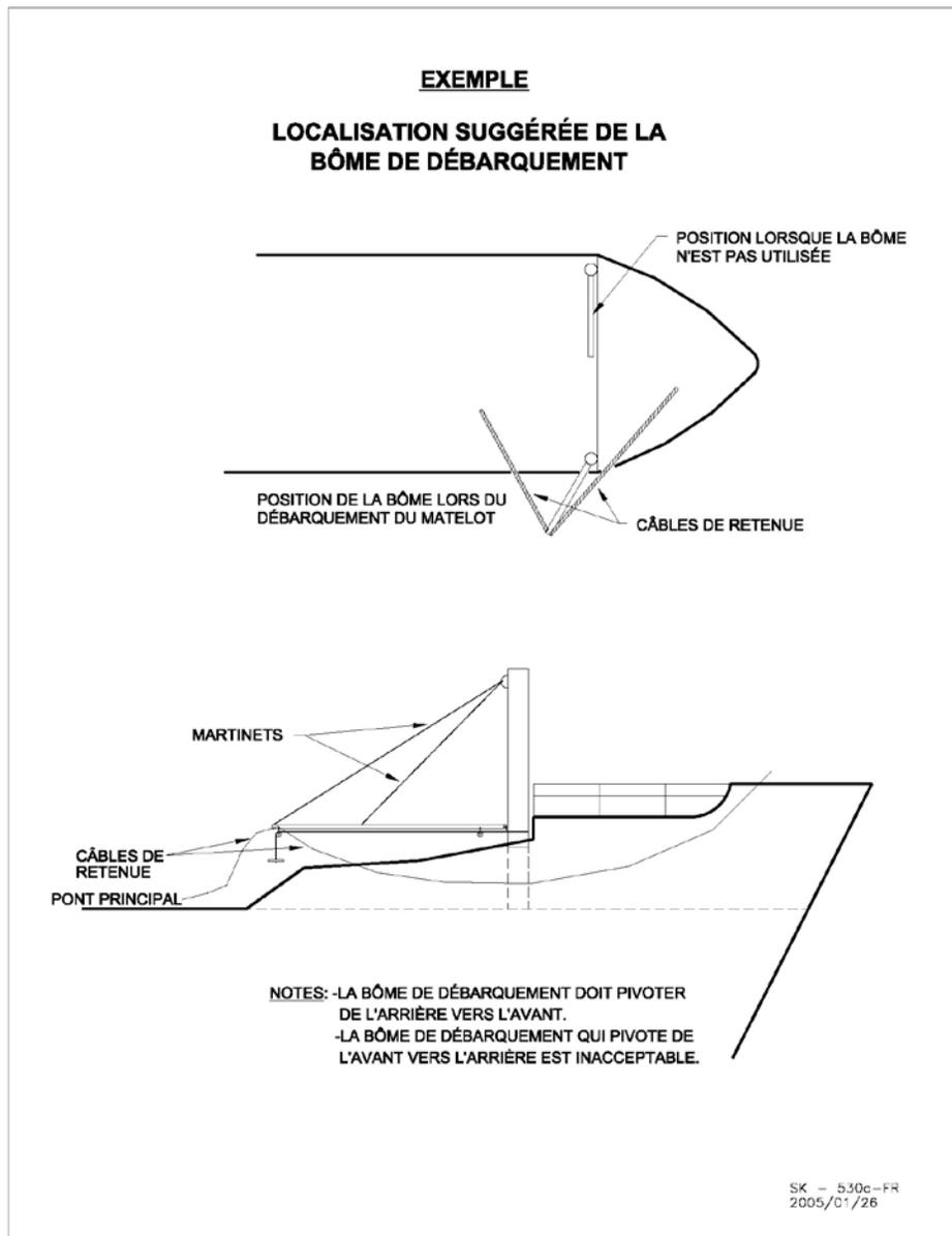
L'installation d'une nouvelle bôme, ou la mise au point d'une bôme existante, devrait être immédiatement suivie d'un test avec un poids statique adéquat afin d'assurer l'intégrité de chaque pièce. On recommande qu'un bloc de sécurité en bois, muni d'un câble assez long pour atteindre la ligne de flottaison, soit placé à proximité de chaque bôme, prêt à être utilisé en cas d'urgence.
