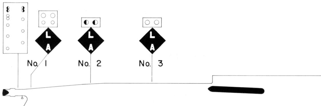
Au moment où la poupe du dernier navire sortant franchit l'écluse, le signal L/A 2 s'éteint, le signal L/A et les feux de circulation sont au vert continu. La proue du navire entrant devrait alors avoir atteint le signal L/A 3. (Figure 5)
